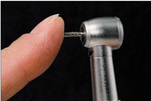
Instrumente dürfen nicht im zahnärztlichen Antrieb wackeln. The instruments should not wobble in the dental handpiece. Les instruments ne doivent pas vibrer dans le contre angle ou la turbine.
